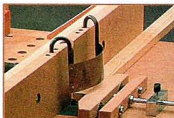
Фрезерование по упору снизу с применением предохранительного приспособления (отталкивателя рук) и зажима.
