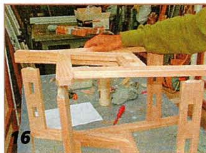
16 Затем устанавливают вторую боковину.
