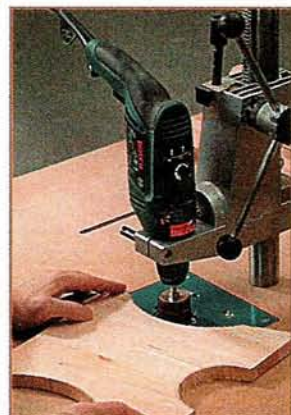
Шлифование кромок заготовки с помощью шлифовальной втулки и дрели, закреплённой в сверлильной стойке.
