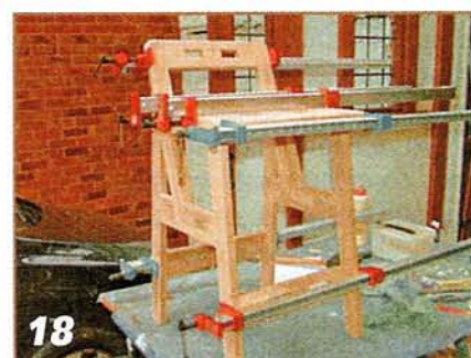
18 Склеенный стул стягивают струбцинами.
