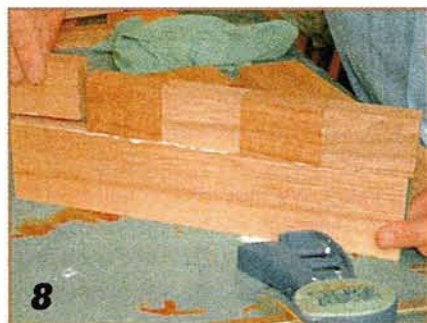
8 Панель склеивают, зажимают струбцинами и выдерживают, пока не затвердеет клей. Для более прочного соединения можно использовать «бисквиты».
