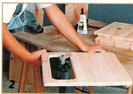
Кромки выкроенных деталей можно обработать фасонной фрезой.
