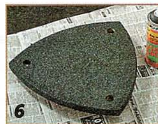
6 Наносят на поверхность спрей под гранит (работать желательно на открытом воздухе!) и покрывают её слоем прозрачного лака.
