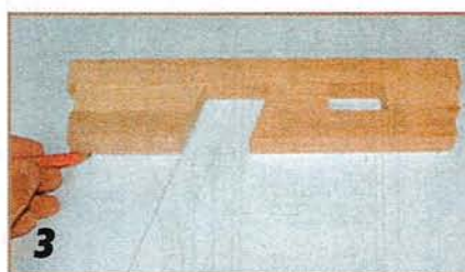
Чтобы проверить размеры боковой перемычки, её накладывают на чертёж.
