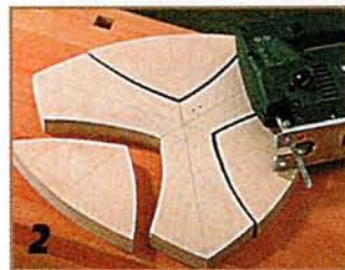
2 Наносят на заготовку контуры и вырезают из неё нижнюю полочку.
