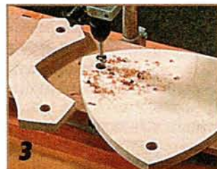
3 В обеих полочках сверлят сквозные отверстия, диаметр которых равен диаметру медных трубок.
