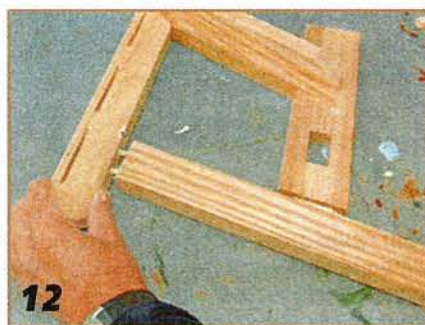
12 Сверху переднюю ножку крепят на шкантах, а с боковой перемычкой соединяют «бисквитом».
