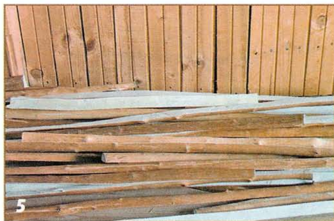
5 Часть заготовок по длине раскряжываем (распиливаем) на половинки.
