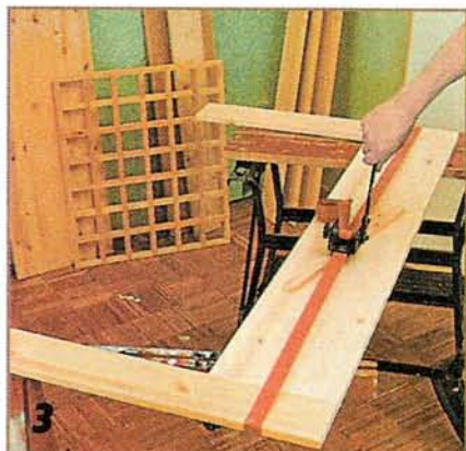
3 Подстолье письменного стола собирают из деталей, выкроенных из столярных щитов.
