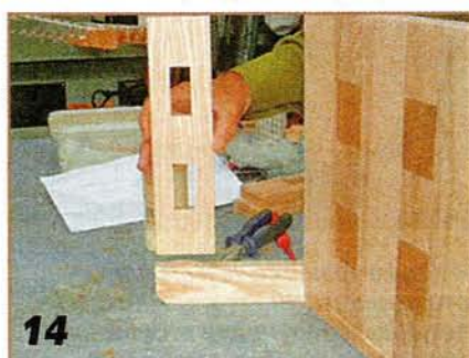
14 С помощью «бисквита» крепят перемычку спинки.
