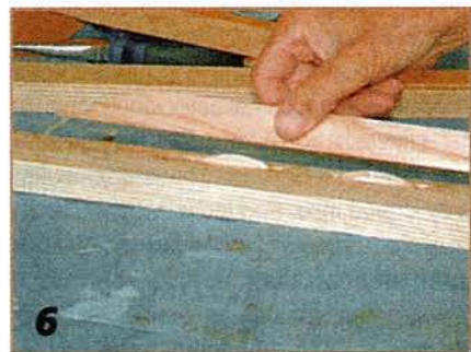
Изготавливают боковые опоры спинки и отпиливают их по длине.
