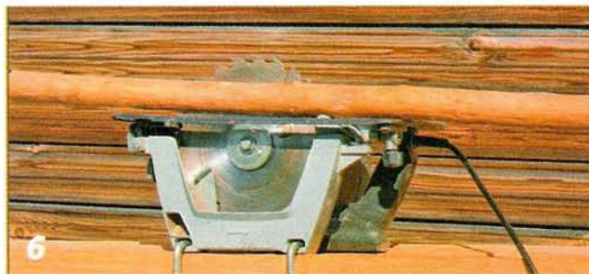
6 «Половинить» заготовки удобно ручной циркуляркой, закреплённой на верстаке.
