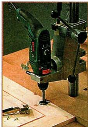
Сверление отверстий с использованием сверлильной стойки, врезанной в стол.
