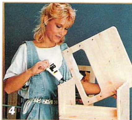
Сборку столика ведут на шкантах с клеем по дереву, например, ПВА.
