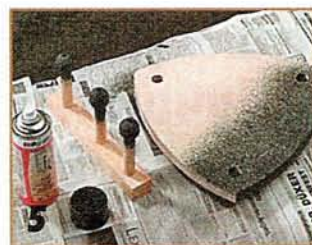
5 Соединение между шариком и брусом круглого сечения выполняют на шкантах с клеем. При покрытии лаком эти детали вставляют в отверстия, высверленные в отрезке деревянного бруска.
