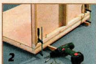
2 По такому же принципу собирают и боковые стенки, которые крепят к полу.
