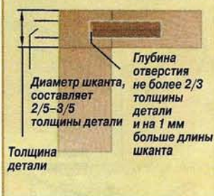
Рис. 1. Соединения на круглых шкантах.
