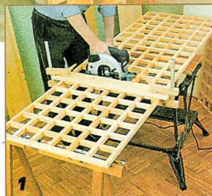
Из большого щита-решётки надо выкроить детали будущего стола — ножки.
