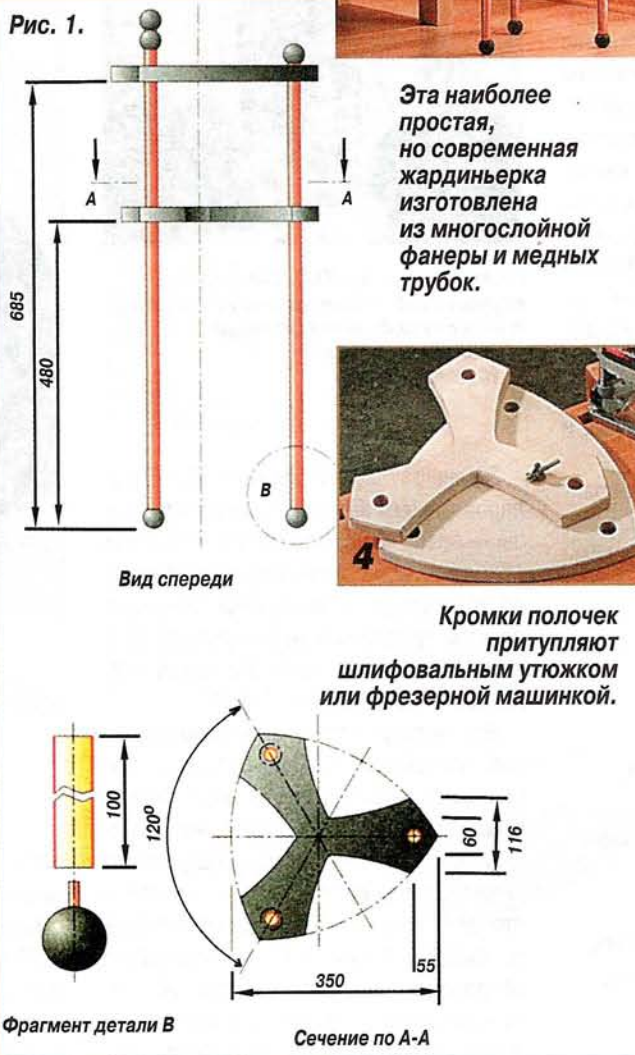
7 Прежде чем приступить к сборке изделия, медные трубки покрывают цапон-лаком. Ножки крепят быстротвердеющим клеем.
