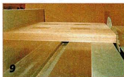
9 Торцы панели сиденья отпиливают под углом 1°.
