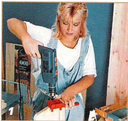
Сверлить отверстия под шканты помогает специальный кондуктор.
