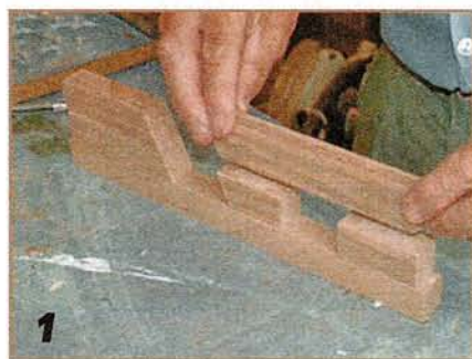
Боковую перемычку собирают из планок.
