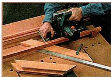
Прямой рез ручной дисковой пилой с помощью углового упора.
