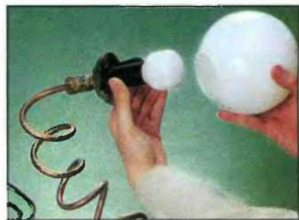
4 Стекланный плафон фиксируем полоской из упругой стали.
