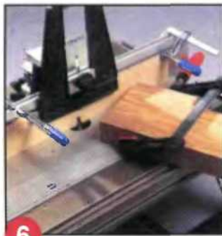
6 В кромках панелей из ДСП отверстия под шкранты сверлят при помощи кондуктора.
