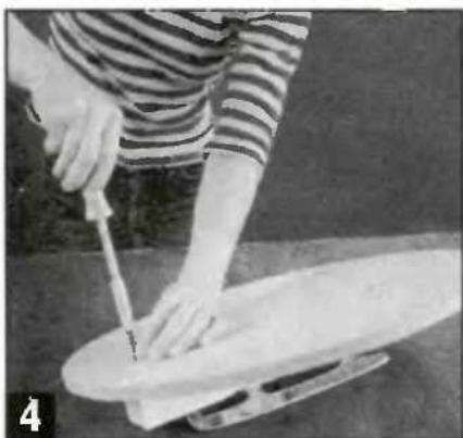
4 Брус (башмак) с рулевым коньком крепят к поворотному кругу.
