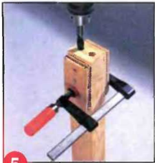
5 Чтобы все фаски были одинаковые, детали обрабатывают фрезой, зажатой в электродреель, сжав струбцинами в пакет.
