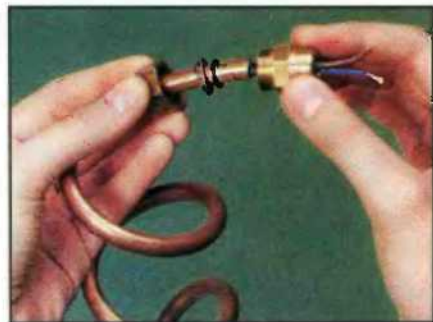
3 Надеваем на трубку штуцер, гайку и винт, зажимаем их при помощи двух ключей.
