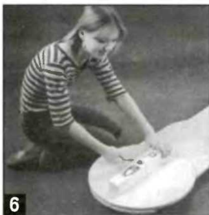
6 Поворотный круг с рулевым коньком крепят к продольной доске при помощи болта МЮх 120 мм. Между доской и кругом проложена фторопластовая шайба, обеспечивающая подвижность соединения.
