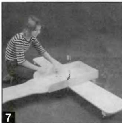
7 Отверстия 6 мм под болты в продольной и поперечной доске сверлят одновременно, сжав их струбцинами.
