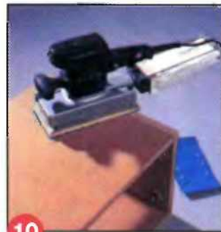
10 От тщательности шлифовки поверхностей зависит внешний вид изделия. Вибрационная шлифовальная машинка - хороший помощник в качественной отделке.
