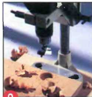
9 Круглые пазы под петли делают фрезой, зажатой в электродреель. Сама дрель закреплена в сверлильной стойке.
