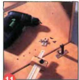
11 Отверстия под полкодержатели размечают рейсмусом. Заворачивать шурупы удобнее аккумуляторным шуруповертом.
