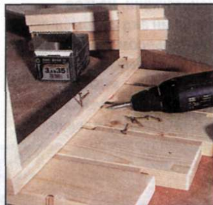
К собранной раме крепят шурупами сначала доски боковых стенок, затем доски днища.
