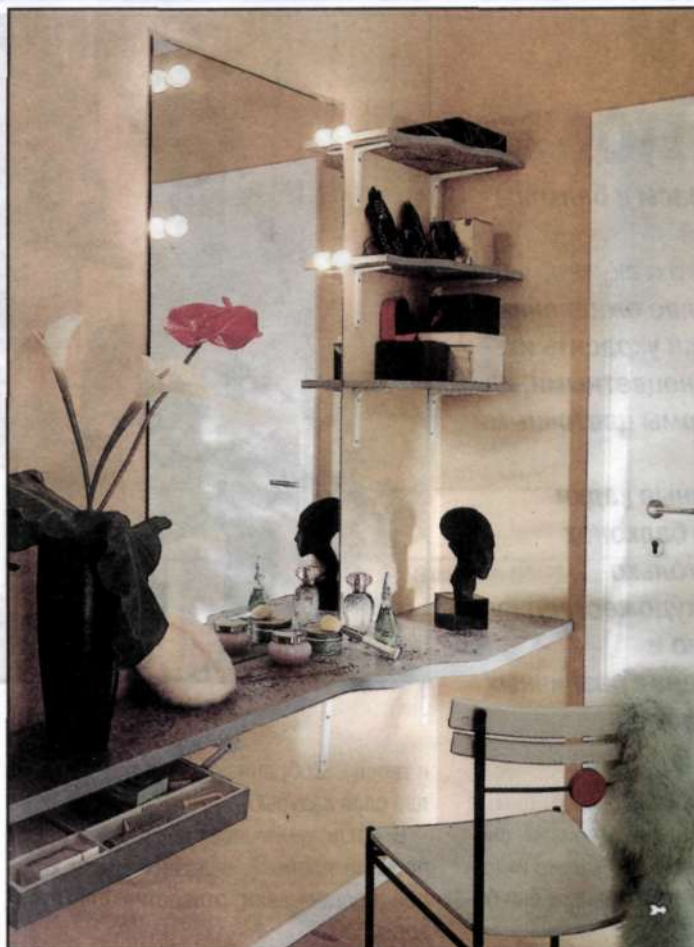
В этой прихожей полки с криволинейными кромками сглаживают впечатление от множества прямых, которыми изобилует интерьер (прямоугольное зеркало, дверной проем, углы помещения). Полки, вырезанные из ламинированной ДСП, прикреплены к стенам с помощью металлических уголков-кронштейнов.
