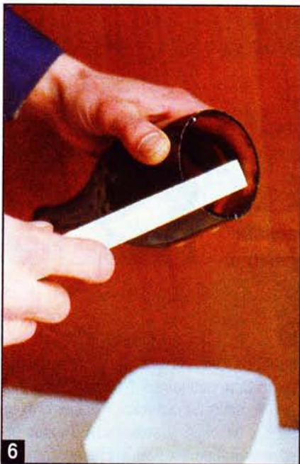
6 Острые края реза нужно притупить абразивным бруском.
