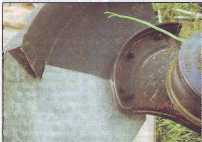
С внутренней стороны видно, что дополнительная защита имеет угол загиба больше, чем штатная защита, и не закрывает нож, служащий для обрезания лески. Скошенная трава не разлетается в разные стороны как прежде, а ложится ровным рядком.
