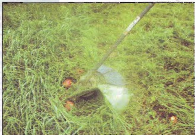
С внутренней стороны видно, что дополнительная защита имеет угол загиба больше, чем штатная защита, и не закрывает нож, служащий для обрезания лески. Скошенная трава не разлетается в разные стороны как прежде, а ложится ровным рядком.
