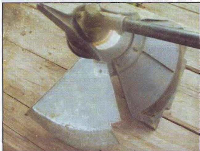
Дополнительная защита к косе крепится тем же винтом, что и ее штатная защита.
