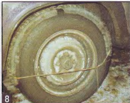
8 Надеваем приспособление сверху на ведущее колесо, пропускаем тросик за колесом под ось автомобиля...
