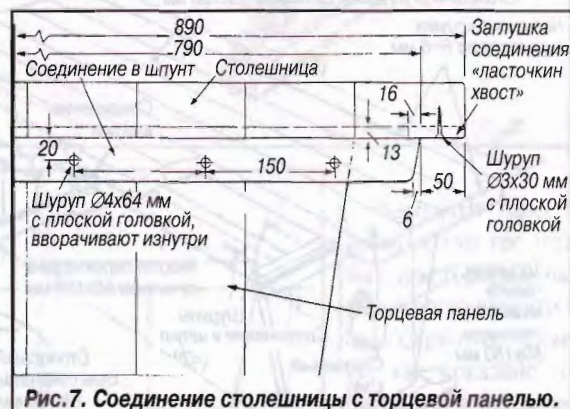
Рис. 7. Соединение столешницы с торцевой панелью.
