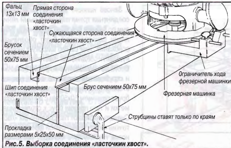
Рис. 5. Выборка соединения «ласточкин хвост».
