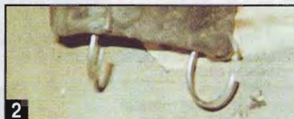
2 Из оцинкованной стальной проволоки Ø 4–5 мм или гвоздей длиной 150 мм делаем кольца, выполняющие роль скрепляющих элементов. Пропускаем их в отверстия на протекторе...
