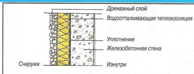
Рис. 5. Теплоизоляция наружной стены подвала.
