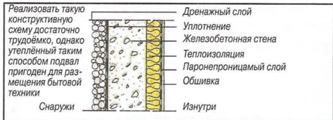
Рис. 6. Наружная стена подвала с внутренней теплоизоляцией.
