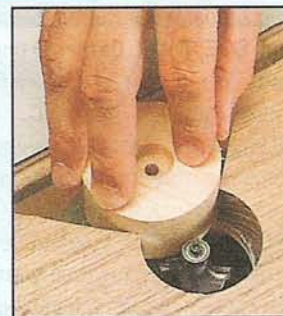
Приспособление (опорная линейка) для снятия фасок с небольших деталей на фрезере.
