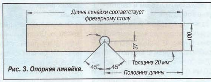
Приспособление (опорная линейка) для снятия фасок с небольших деталей на фрезере.
